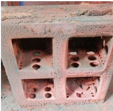
Рис. 2 – Мультивихревой сепаратор в окрасочно-сушильной камере
