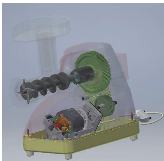
Рис. 2. Цикл работы мясорубки в разрезе
