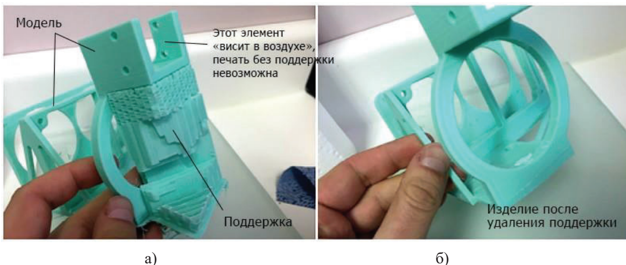
Рис. 2. Распечатанная модель с поддержкой (а) и после её удаления (б)
