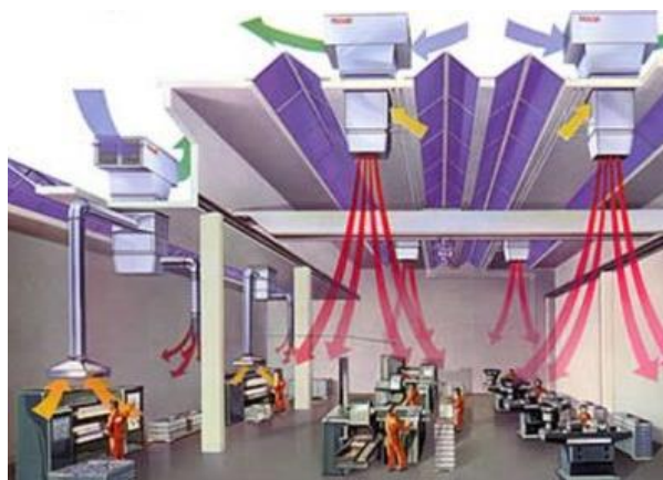
Рис. 8. Общеобменная канальная вентиляция
