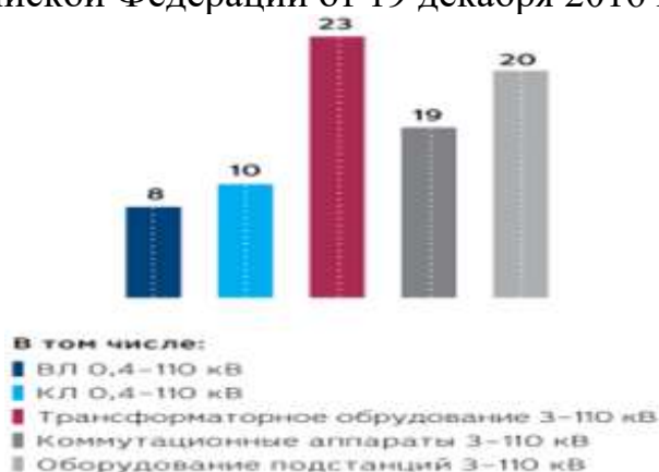
Рис.3. Уровень износа объектов электросетевого хозяйства по состоянию на 31 декабря 2020 года [3].
