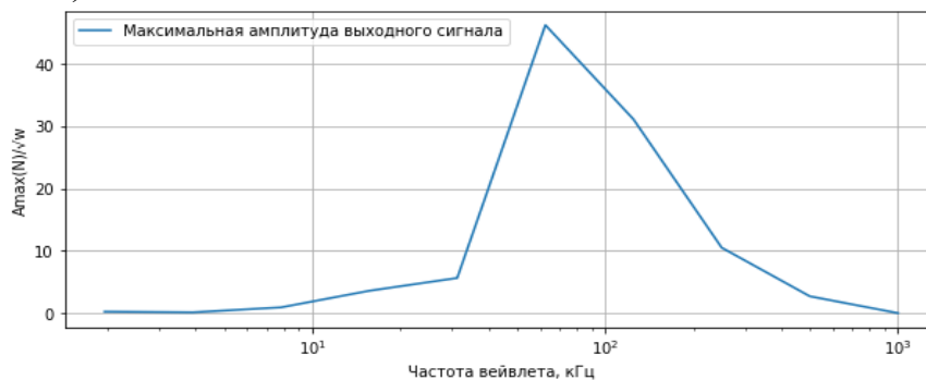
Рис.4. Зависимость амплитуды преобразованных сигналов от частоты (масштаба) материнского вейвлета.
