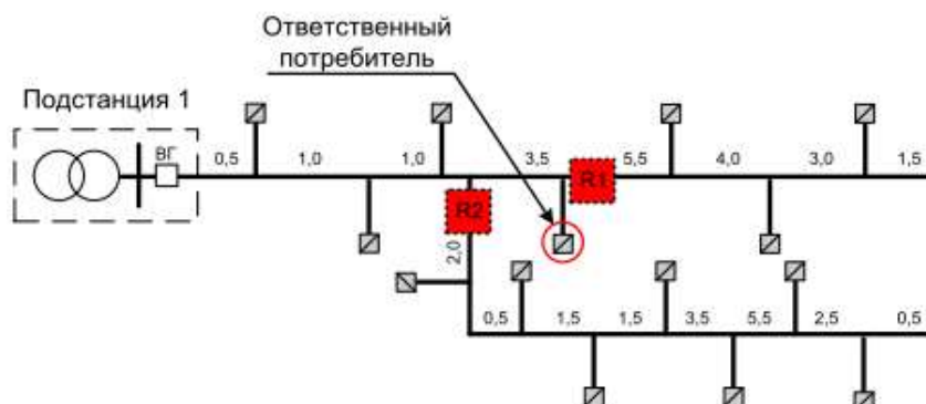
Рис. 3. Установка реклоузеров для повышения надежности ответственного потребителя на радиальном фидере [4,5]
