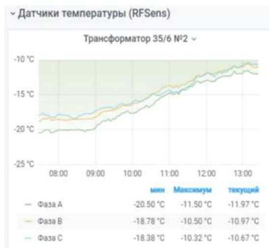
Рис.2. Показания датчика температуры фаз трансформатора ПАО «Татнефть»
