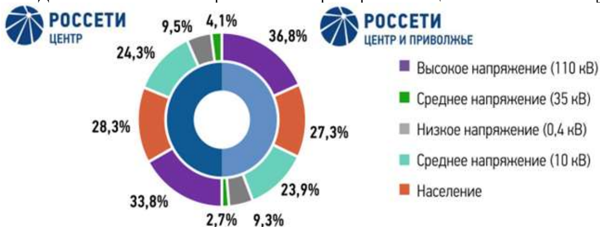
Рис. 2. Распределение ЛЭП по классам напряжений «Россети Центр» и «Россети Центр и Приволжье»[4].
