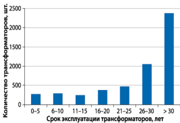
Рис. 4. Распределение трансформаторов по срокам эксплуатации на семь возрастных групп [4].
