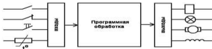
Рис.1. Схема работы логического реле
