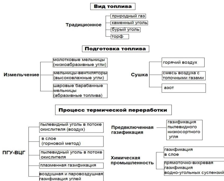
Рис. 2. Алгоритм выбора технологической схемы производства энергии с газификацией угля
