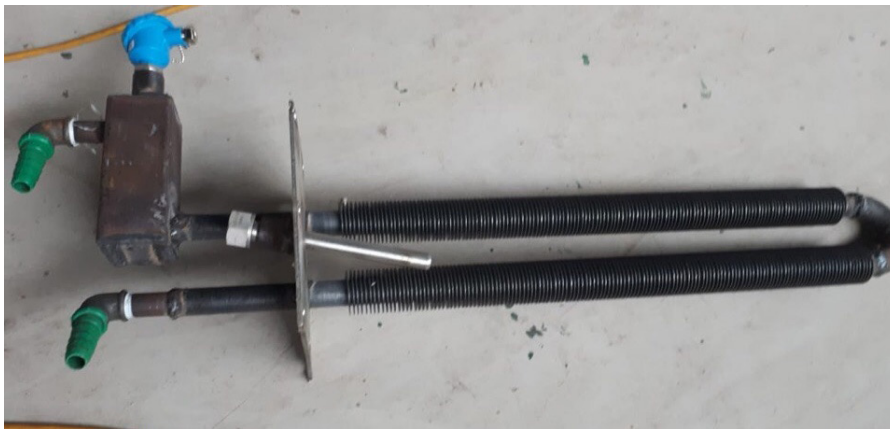
Рис. 1. Рекуперативный теплообменный аппарат с ребристой поверхностью
