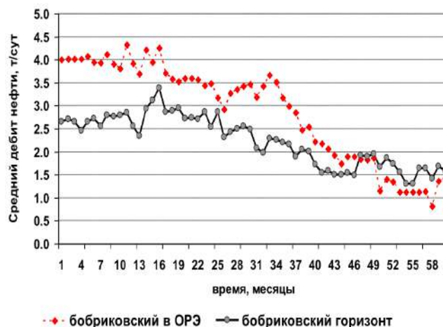
Рисунок 6 – Динамика среднего дебита нефти по бобриковскому горизонту в скважинах ОПЭ и ведущих отдельную эксплуатацию бобриковского горизонта
