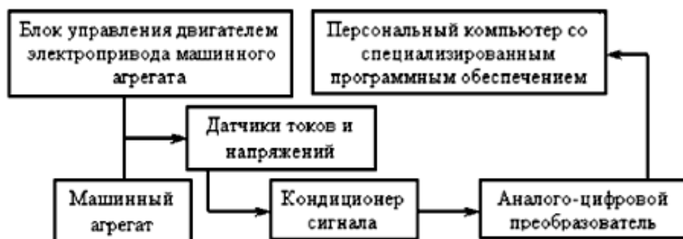
Рис. 4. Структурная схема диагностического комплекса для реализации спектрального метода диагностики оборудования
