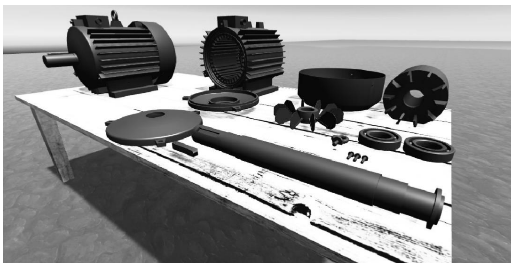
Рис. 2. Вид основного блока по сборке-разборке асинхронного двигателя ремонтного цеха
