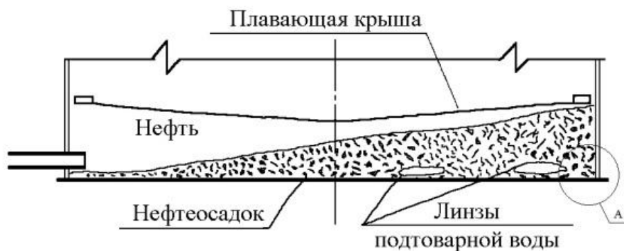
Распределение донных отложений и характерные зоны по уровню коррозионного поражения нижнего пояса стенки резервуара РВСП-50000
