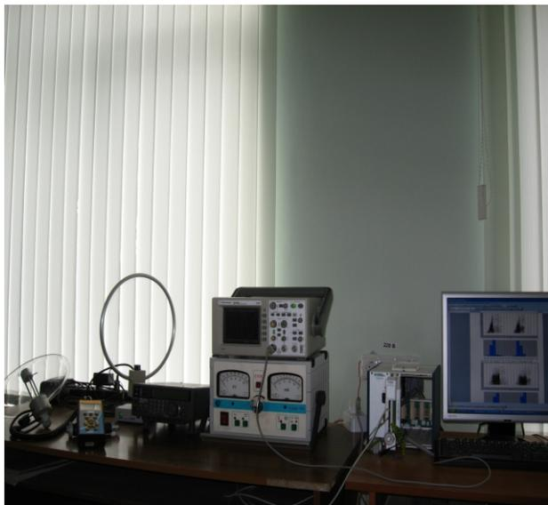
Разработанный в настоящее время аппаратно-программный комплекс, предусматривает возможность регистрации большого количества импульсов ЧР и их интегральное распределение по амплитудам. Из этой характеристики определяются такие параметры как средний кажущийся заряд, максимальный кажущийся заряд, частоты следования импульсов ЧР и средний ток ЧР. Анализ различных экспериментальных данных показал, что наиболее эффективным представлением данных являются амплитудно-фазовые диаграммы (АФД) сигналов ЧР.
