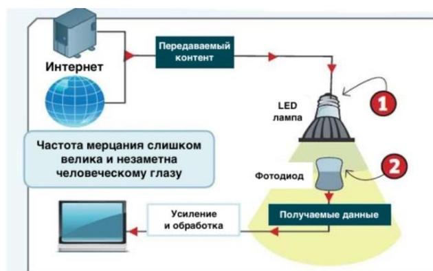
Рис. 1. Схема работы технологии VLC
