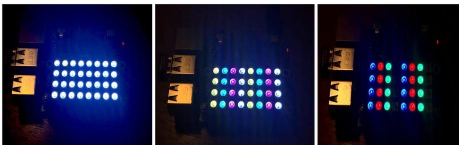
Рис. 2. Изображений светодиодной матрицы при управлении при управлении одноплатным микрокомпьютером Raspberry Pi
