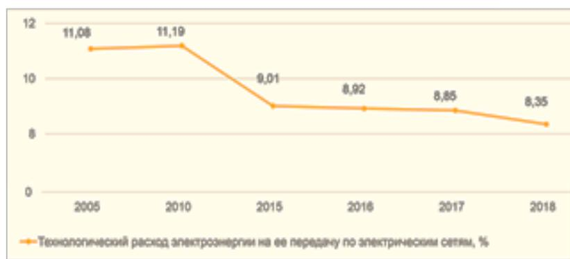
Рис. 1. Динамика изменения технологического расхода электрической энергии на транспорт в электрических сетях РБ
