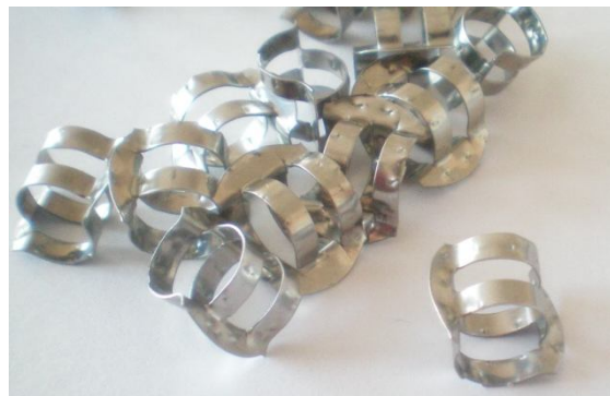
Рис. 7.7. Элементы насадки «Инжехим 2003-М»
