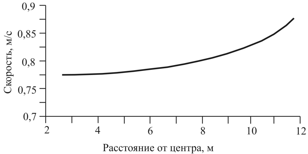
Рис. 9.6. Профиль скорости воздуха в сечении входа в слой насадки в воздухораспределителе
