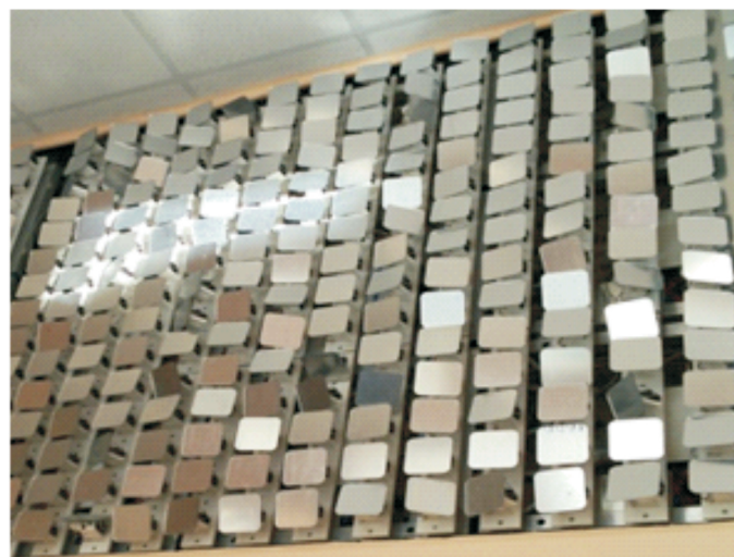
Рис. 2. Внешний вид отражателей экспериментальной системы автоматического перераспределения света внутри помещения
