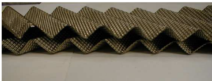
Рис. 11.14 Элементы пластин насадки.
