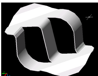
Рис. 11.26 Элементы насадки «Инжехим–2002».
