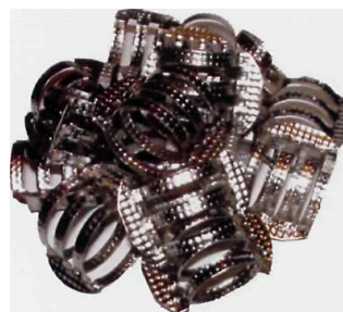
Рис. 11.19 Нерегулярная насадка «Инжехим–2000» с шероховатой поверхностью.
