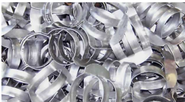
Рис. 3.28 Вид насадочного слоя.
