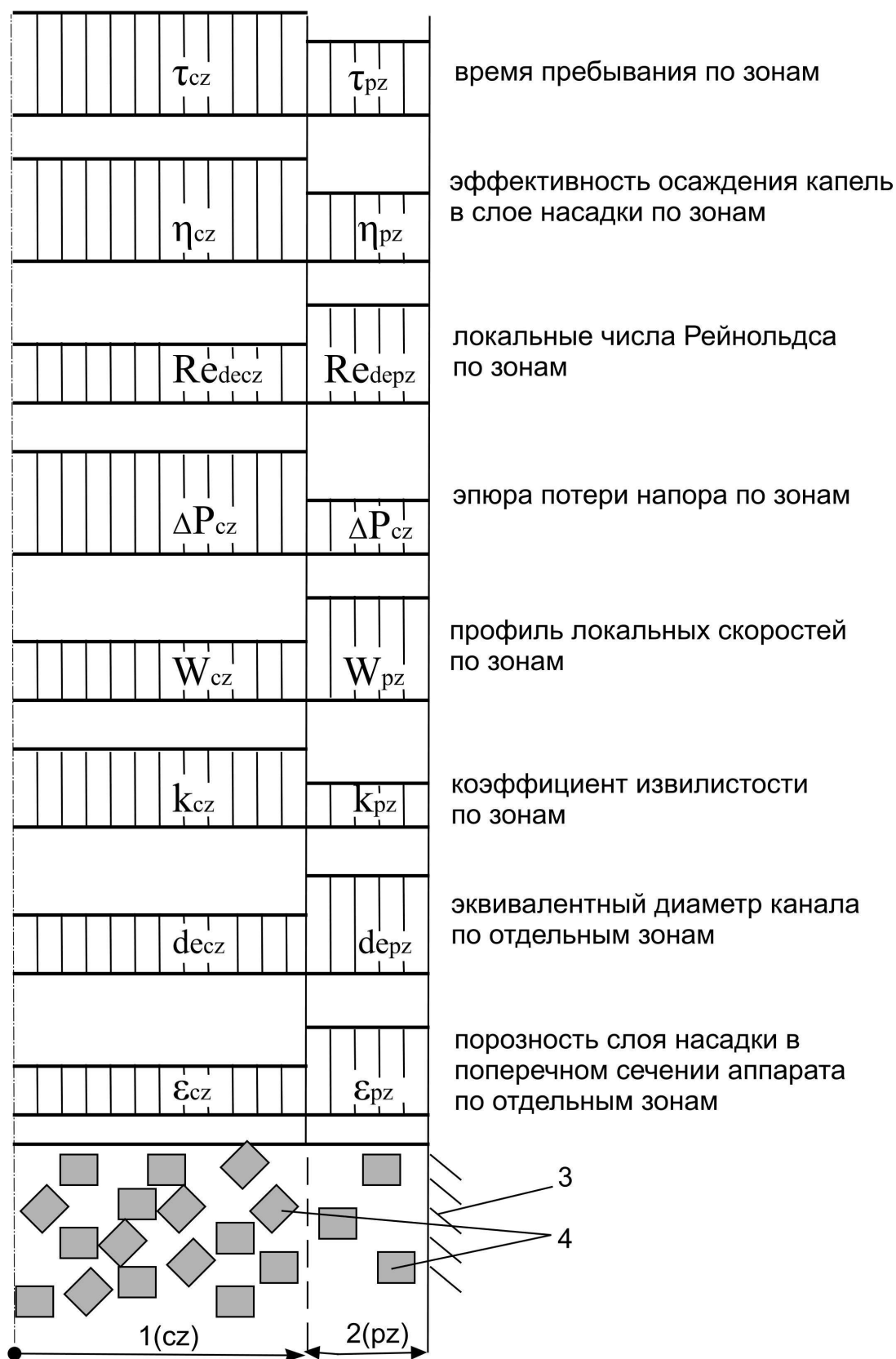
Рис. 9.4 Структурная модель колонного аппарата с насыпной насадкой. Распределение локальных параметров по зонам: 1 – центральная область колонного аппарата с насадкой; 2 - пристенная область с повышенной порозностью; 3 – стенка аппарата; 4 – элементы насыпной насадки.
