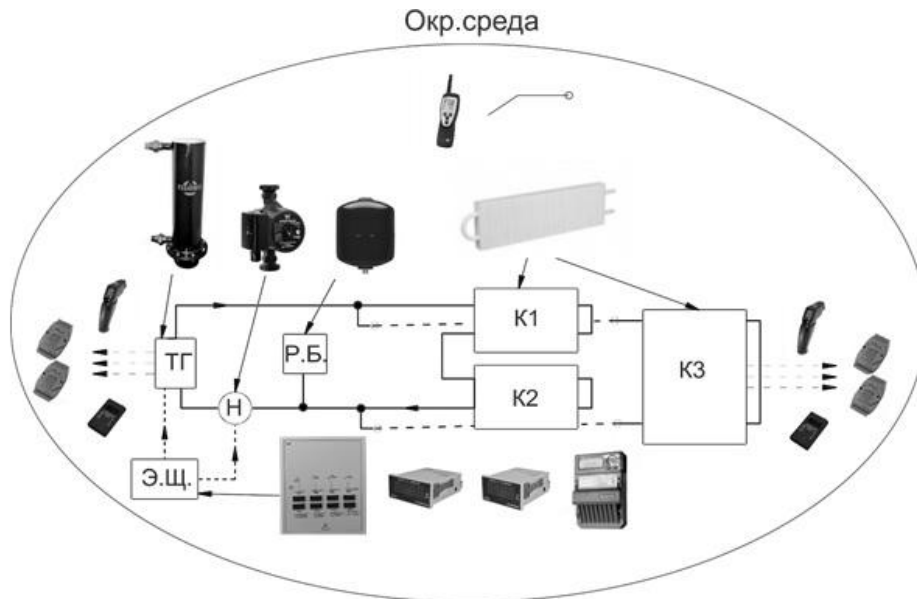
Рис. 1. Основные блоки источника энергии в виде лабораторно-вычислительного стенда «Децентрализованная система отопления с электродным источником теплоты». ТГ – преобразователь электрической энергии в тепловую энергию теплоносителя в виде электродного теплогенератора (горячий источник); К – холодный источник в виде конвекторов марки «Комфорт»; Н – электрический насос марки Grundfos; Р.Б. – расширительный бак; Э.Щ. – электрический щит
