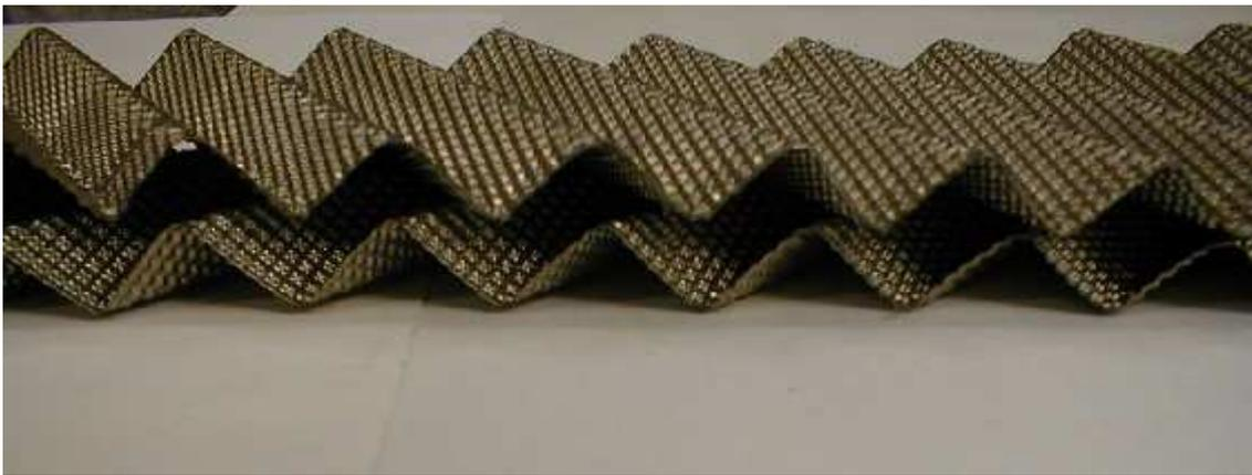
Рис. 5.6. Элементы пластин насадки
