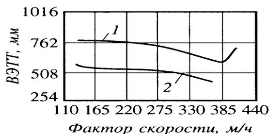
Рис. 6.14. Зависимость эффективности (ВЭТТ) от фактора скорости для металлических колец:
