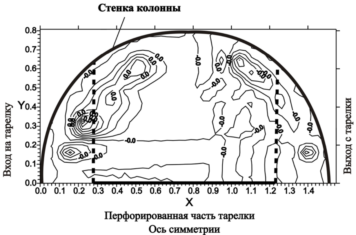
Рис. 8.12. Профиль безразмерной составляющей скорости v на тарелке в сечении z = H/4
