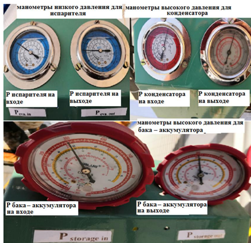
Рис. 3.13. Манометры испытательной установки
