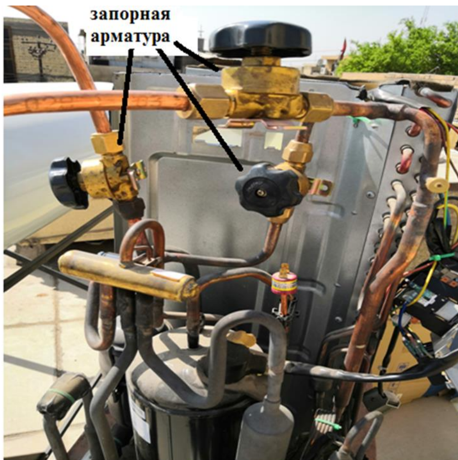
Рис. 3.10. Фотографии запорной арматуры на экспериментальном стенде
