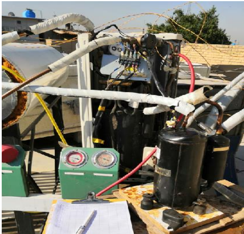
Рис. 3.21. Фотография испытательного устройства с замененным компрессором.
