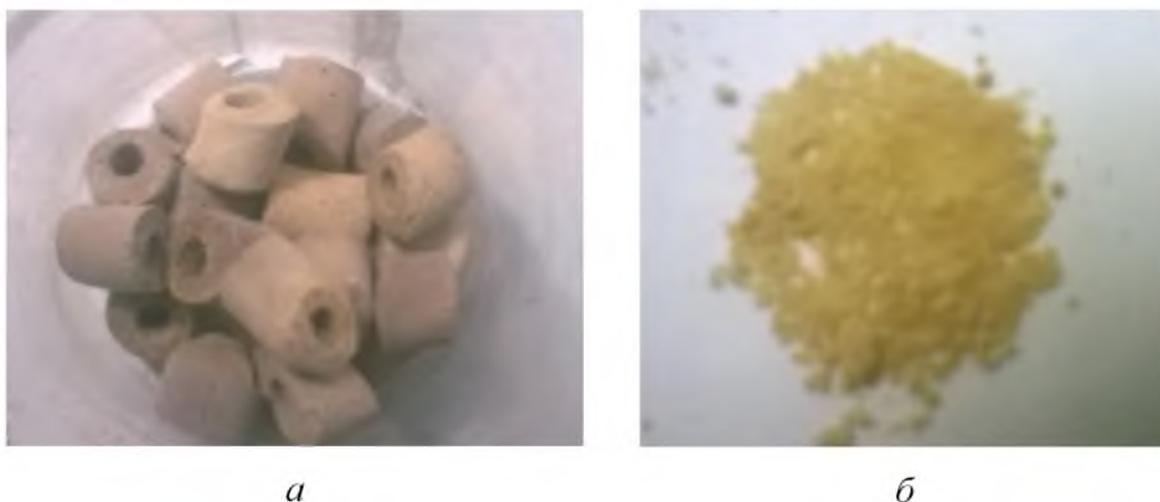
Рисунок 4.5—отработанный (деактивированный) образец катализатора КУ-2ФПП–а; экстракт, полученный в процессе СКФЭ регенерации ( $T = 393\text{K}$  и  $P = 20$  МПа)–б
