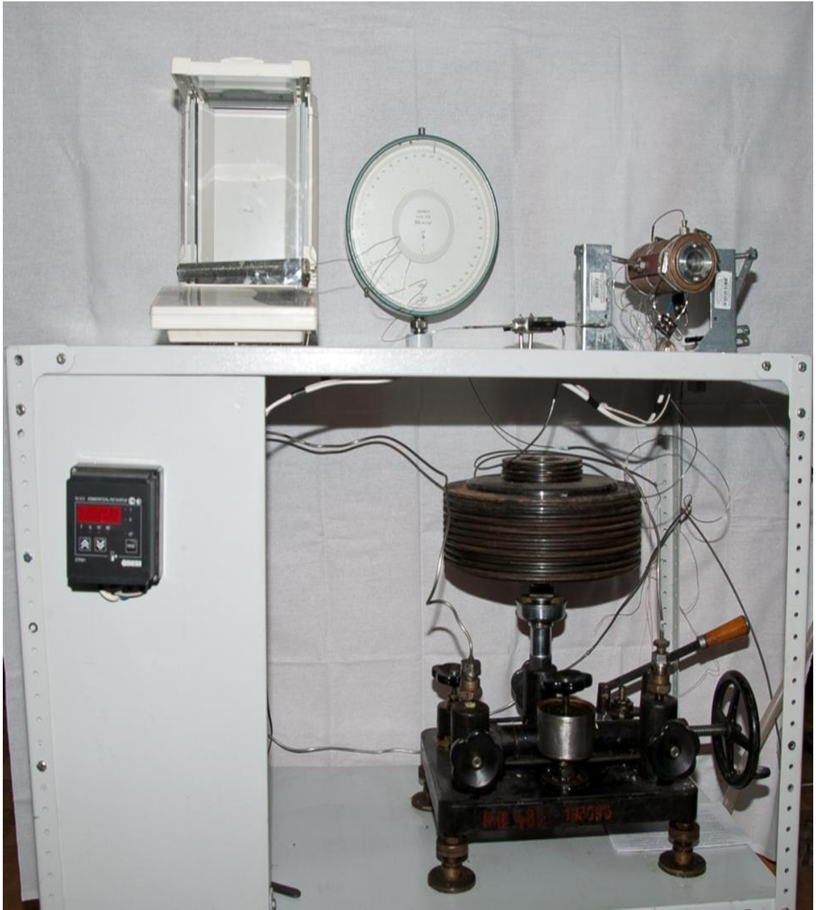
Рис. 3.5. Внешний вид экспериментальной установки для исследования фазового равновесия бинарных систем.
