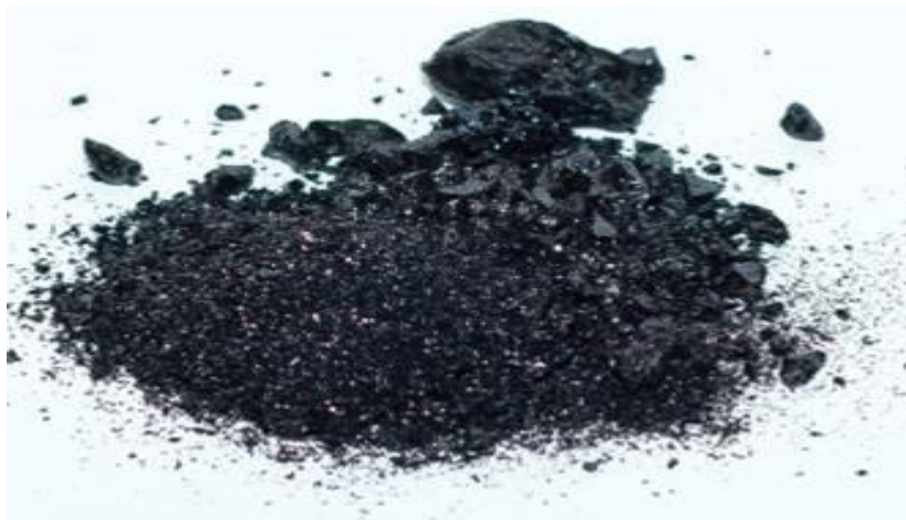
Рис. 5.5. Асфальт, полученный при деасфальтизации нефтяных остатков пропан-бутановой смесью.
