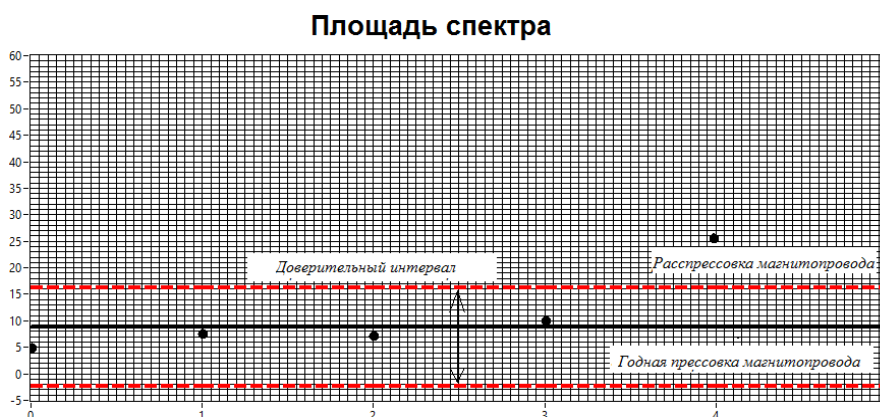
Рисунок 12 – Результаты оценки технического состояния магнитопровода силового трансформатора ТСЗ 16 кВА по целевой функции «Площадь спектра»
