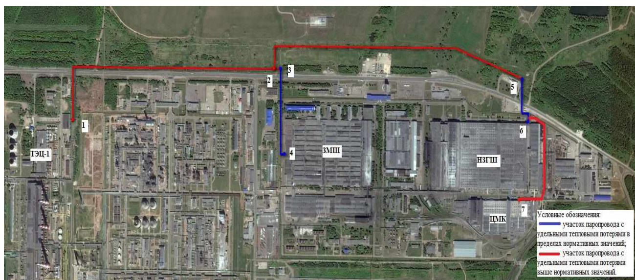
Рис.1.1 Схема пароснабжения паром «30» от Нижнекамской ТЭЦ-1 до объектов шинного комплекса ПАО «Татнефть»
