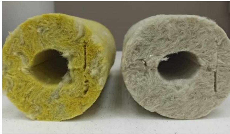
Рис. 3.12 Теплоизоляционные цилиндры Экоролл плотность 80 \text{ кг/м}^3 , слева – новый образец; справа – после 12 часов при температуре 650 \text{ °C} (связующее полностью выгорело)
