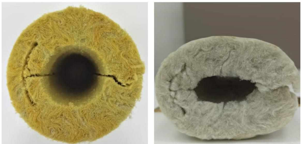
Рис. 3.15 Внешний вид образцов теплоизоляционных цилиндров из базальтового волокна до и после полного выгорания связующего: а) образец 1; б) образец 2; в) образец 3
