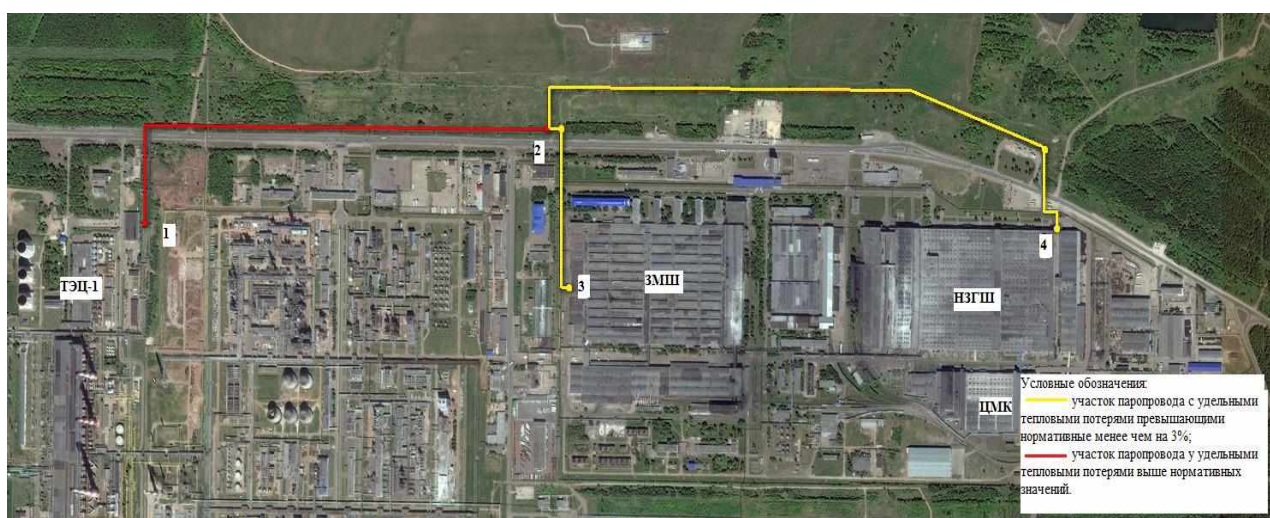
Рис.1.2 Схема пароснабжения паром «15» от Нижнекамской ТЭЦ-1 до объектов шинного комплекса ПАО «Татнефть»
