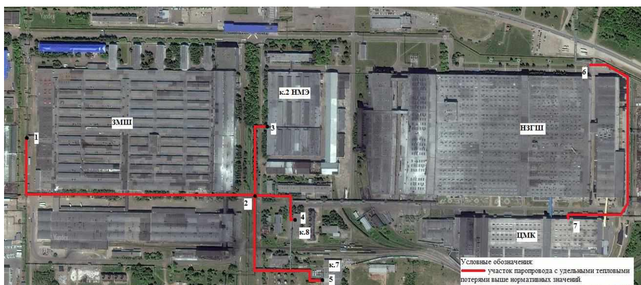
Рис.1.3 Схема пароснабжения паром «15» объектов шинного комплекса (по территории ПАО «Нижнекамскшина»)
