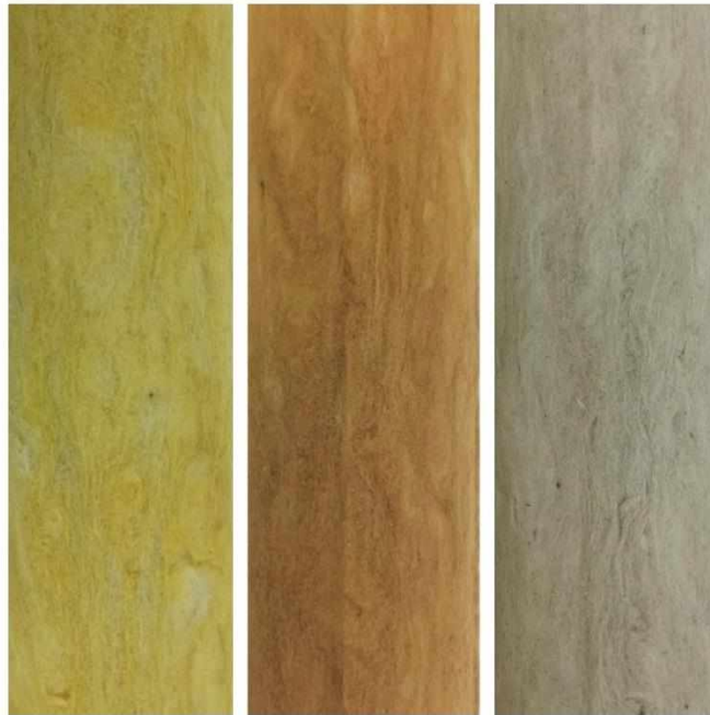
Рис. 3.14 Теплоизоляционные цилиндры BOS плотность 100 \text{ кг/м}^3 вид сверху, (слева направо) новый образец; после 12 часов при температуре 250 \text{ °C} (степень конверсии 0,2); после 12 часов при температуре 650 \text{ °C} (связующее полностью выгорело)
