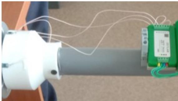
Рисунок 4.14. Полумостовая схема с 3-х проводной схемой подключения тензорезисторов
