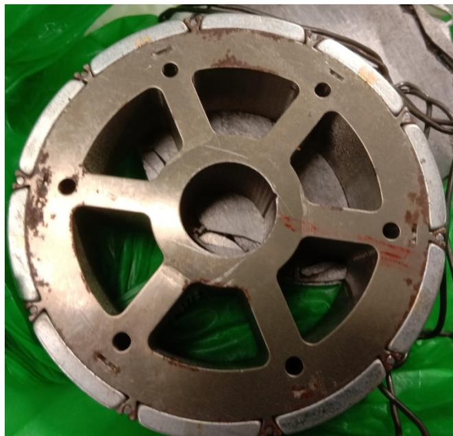
Рисунок 3.4. Ротор с поверхностным расположением магнитов
