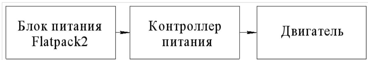
Рисунок 4.1. Схема системы питания СДПМ
