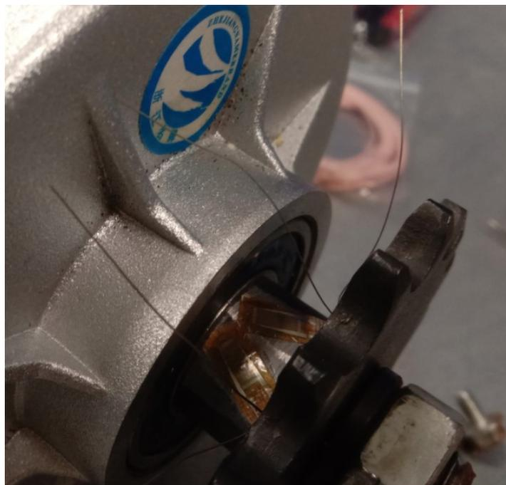
Рисунок 4.15. Установка тензорезисторов на валу ЭД
