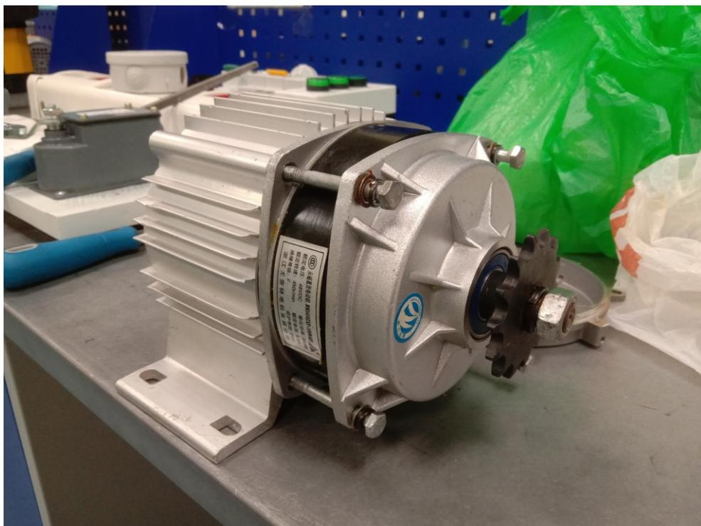
Рис 3.3. Двигатель VM1418 ZXF
