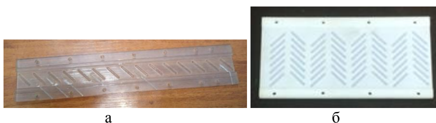
Рис.6. Схемы многорядной (а) и однорядной (б) систем овально-траншейных выемок
