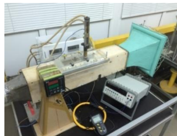
Рис.2. Схема рабочей установки: 1 - ВДН; 2 - рабочий канал; 3 - нагреваемая интенсифицированная металлическая пластина; 4 - трубка Пито - Прандтля; 5 - термопара; 6 - нагреватель; 7 - входное устройство (сопло Витошинского); 8 – токоизмерительные клещи; 9 - ЛАТР; 10 – мультиметр.
