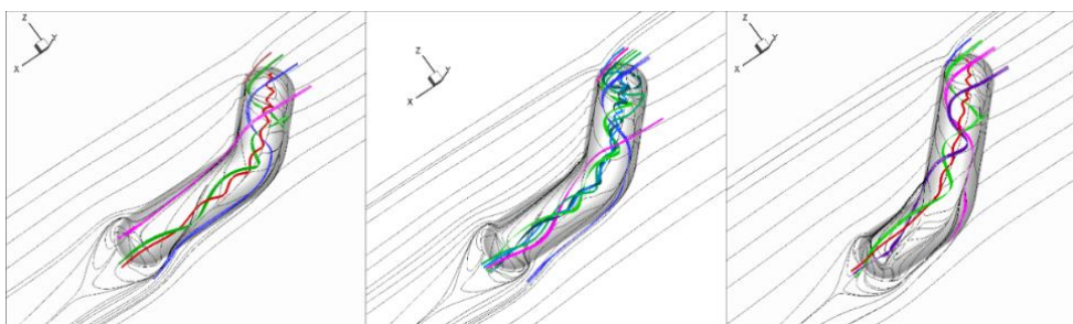
Рис.18. Результаты численного исследования развития течения в выемках с геометрическим параметром l_1/l = 0,4, 0,6, 0,7 .
