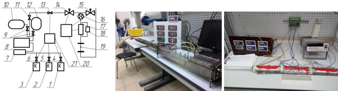
Рис.3. Схема экспериментального стенда: 1-3 – компрессор; 4-6, 13 - клапан электромагнитный двухпозиционный пилотного действия; 7 - фильтрационный модуль для очистки сжатого воздуха; 8 - осушитель; 9, 11 - вентили; 10,12 - ресиверы; 14 - шаровый кран с электроприводом; 15 - шаровый кран с электроприводом для перепуска; 16 - ультразвуковой расходомер-счетчик газа; 17 - нагреватель; 18 - источник энергии для нагревателя; 19 - рабочий участок; 20 - контроллер; 21 - щиток для управления клапанами 4-6, 13
