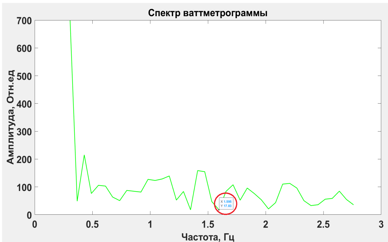
Рисунок 2.23. Спектр ваттметрограммы при нормальной работе ШСНУ без образования эмульсии
