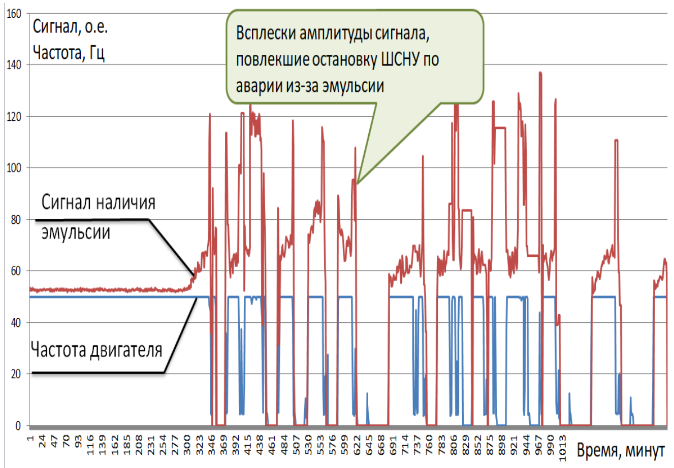
Рисунок 4.14. Диаграмма работы ШСНУ с отключенной системой защиты от эмульсии
