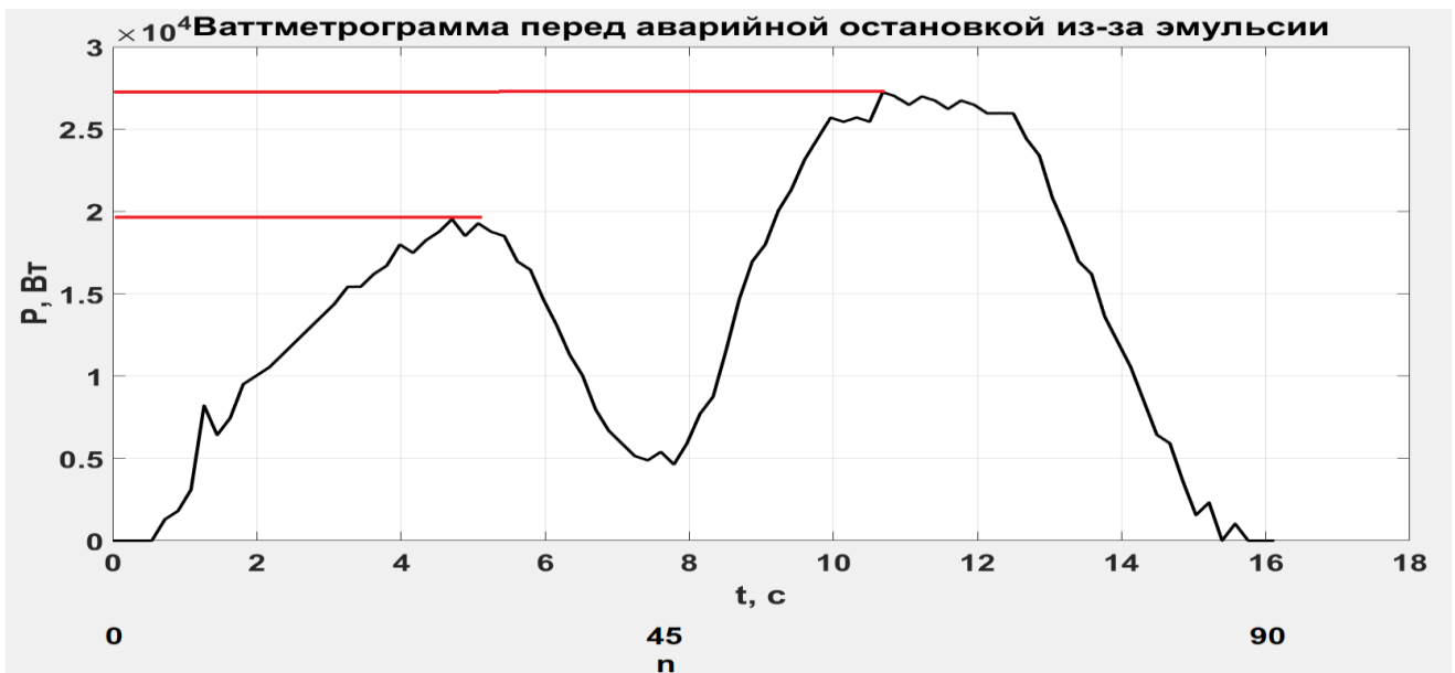
Рисунок 2.25. Ваттметрограмма при максимальном образовании эмульсии в цилиндре насоса ШСНУ
