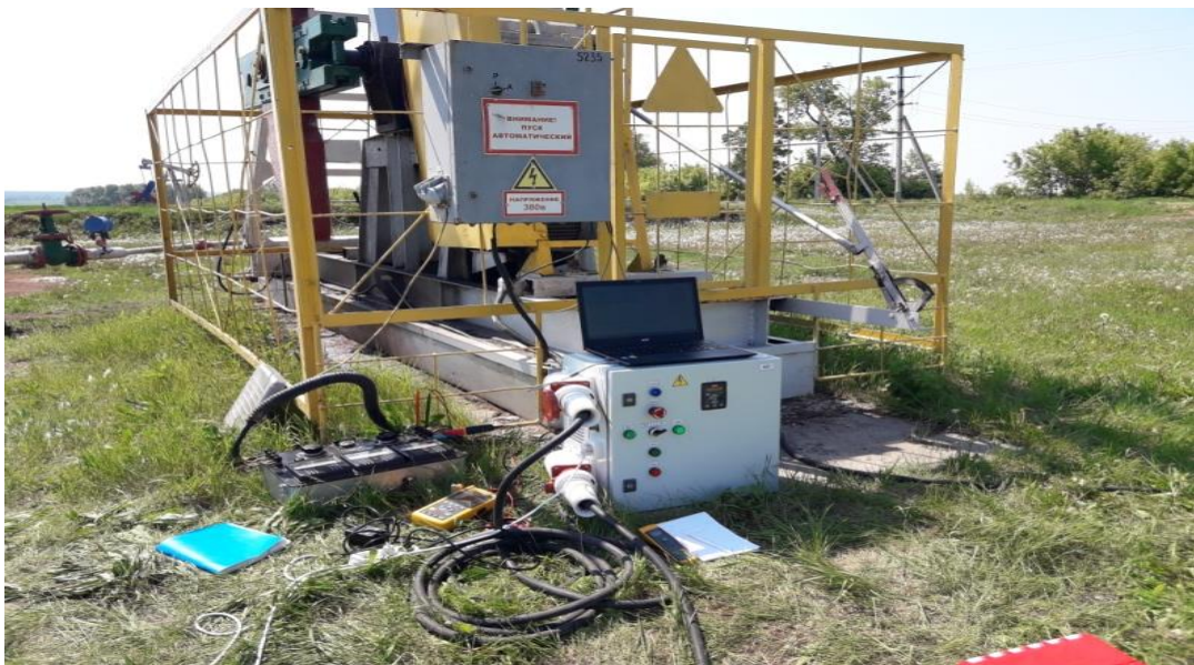
Рисунок 4.1. Размещение оборудования на ШСНУ при проведении экспериментов
