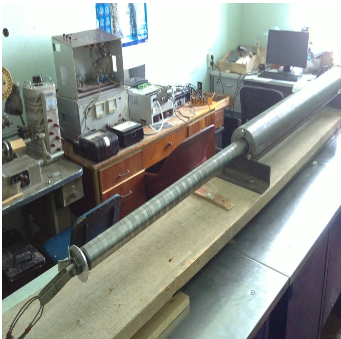
Рис. 1.8 Испытательный стенд ЦЛВД с преобразователем частоты и СУ.
