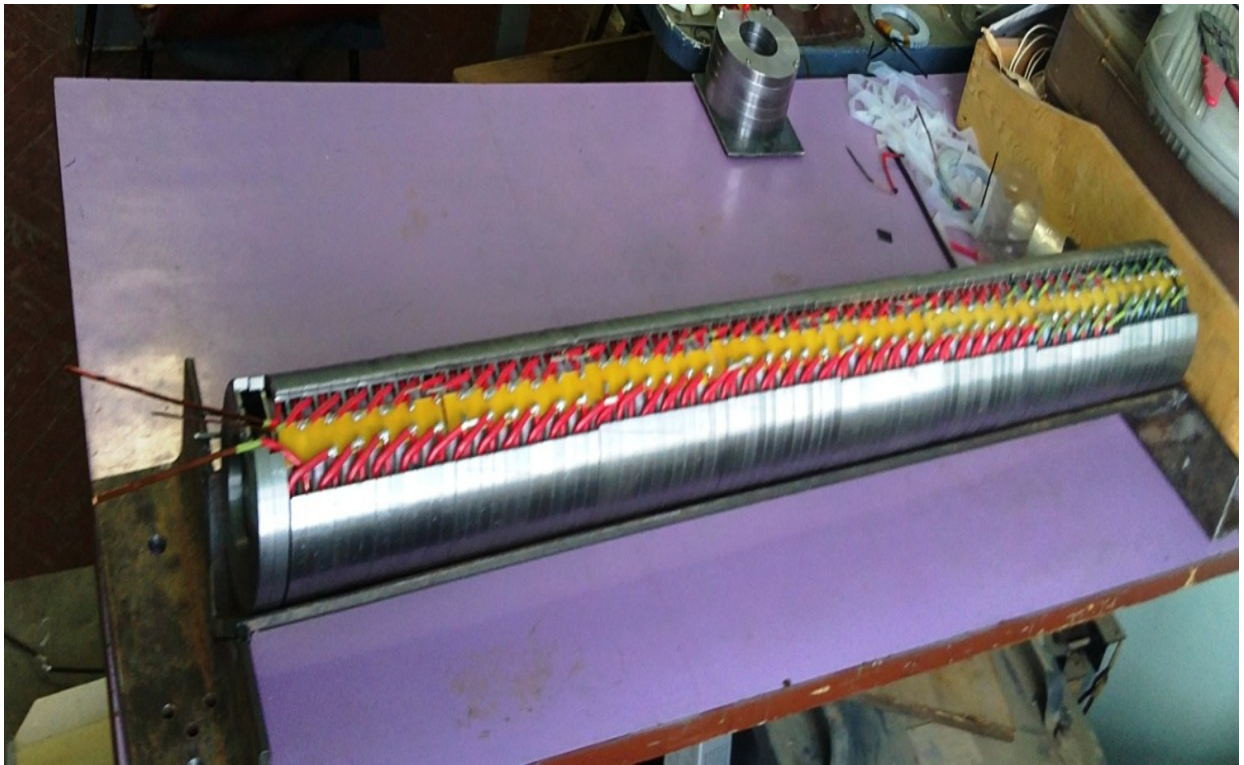
Рис. 1.4 Магнитная система статора с обмотками прототипа ЦЛВД.
