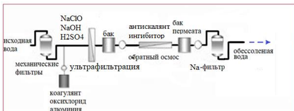
Рис. 2.6. Принципиальная технологическая схема существующей водоподготовки на Ашальчинском поднятии
