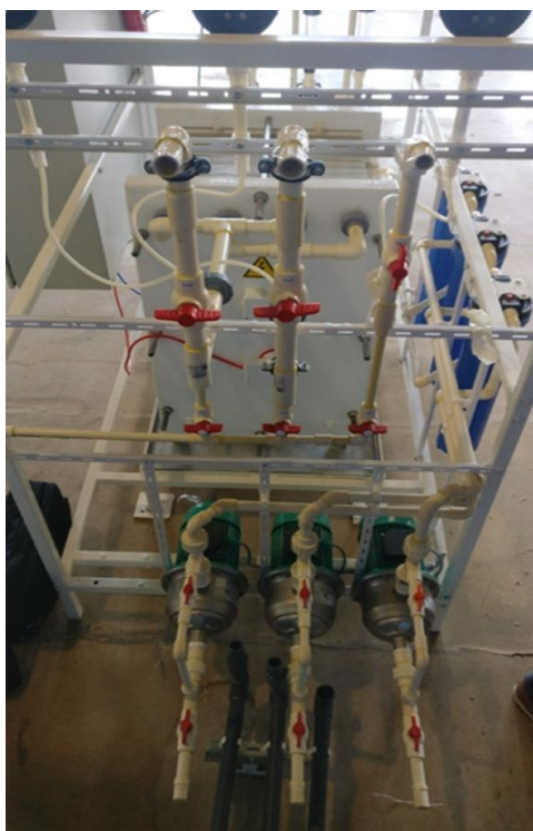
Рис. 5.8. Электродиализный аппарат экспериментальной опытно-промышленной электромембранной установки
