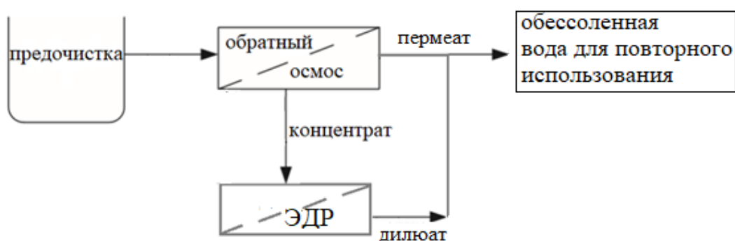
Рис. 1.5 Комбинированная технология обессоливания воды с последовательностью обратный ОО-ЭД
