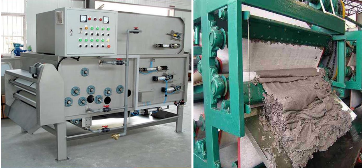
Рис. 6.16. Фотография фильтр-пресса обезвоживания гипсового шлама установки утилизации отходов на Казанской ТЭЦ-3
