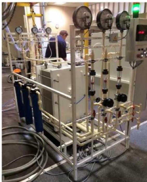
Рис. 2.13 Электромембранная установка ЭМУ-1 с электромембранным аппаратом ЭМА-200/2Т в сборе
