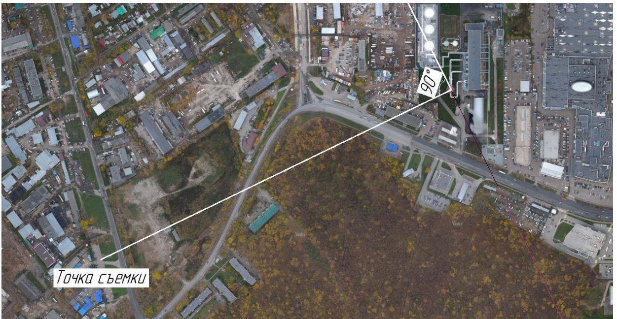
Рисунок 4.1.5 — Определение угла между направлением дымового факела и направлением на трубу с точки съёмки с помощью спутникового снимка
