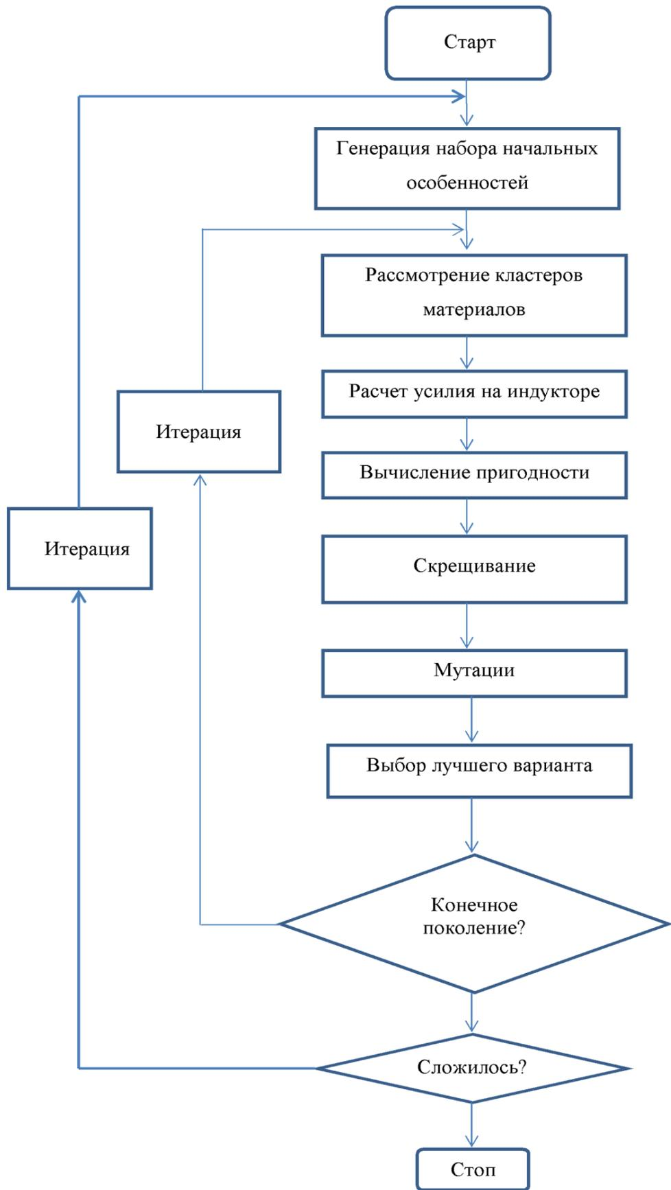
Рисунок 5.15. Блок-схема топологической оптимизации
