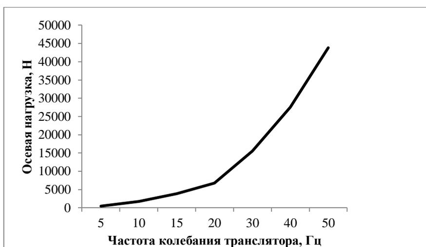
Рисунок 4.13. – Рассчитанная теоретическая зависимость осевой нагрузки на транслятор от частоты индуктора
