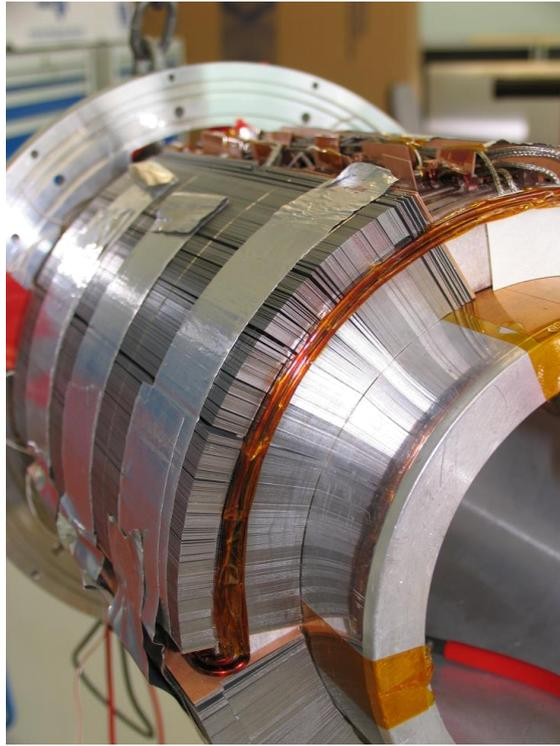
Рисунок 6.31. Укладка статора и соединение катушек
