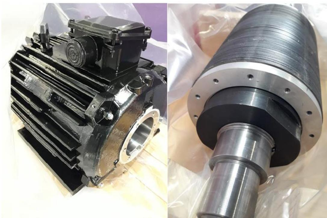
Рисунок 5.11. Опытный образец синхронного двигателя 11 ДВМ160
