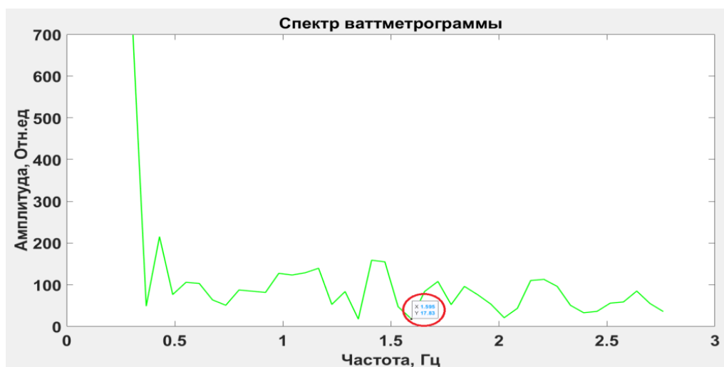
Рисунок 2 – Спектр ваттметрограммы при работе без образования эмульсии
