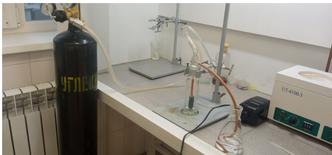
Рисунок 2.9 – Лабораторная установка улавливания углекислого газа.
