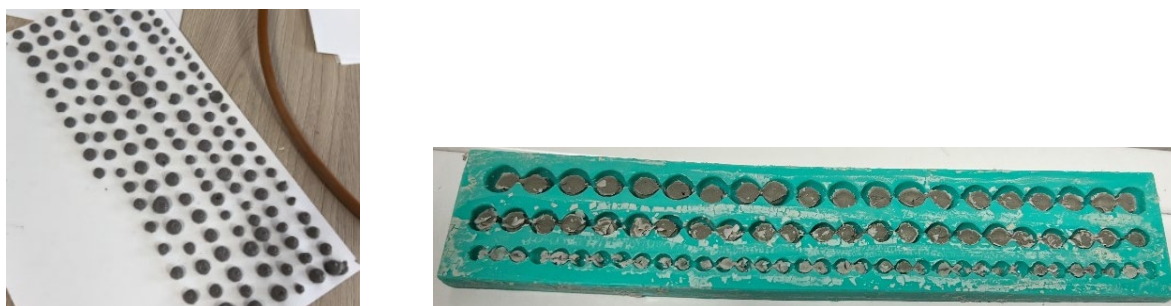
Рисунок 2.6 – Внешний вид готового адсорбента для улавливания соединений серы.
