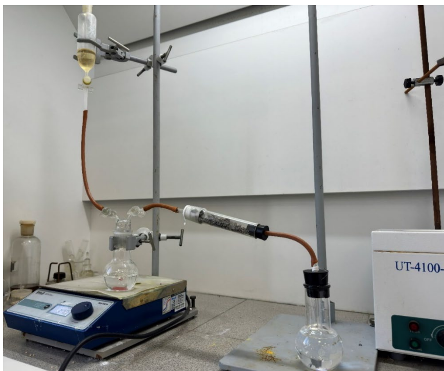
Рисунок 2.5 – Общий вид установки для тестирования адсорбентов по поглощению H_2S .
