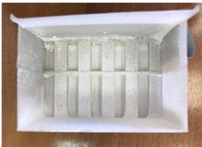
Рисунок 3.12 – Двутавровые элементы в прямоугольном корпусе после эксперимента
