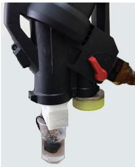
Рисунок 3.9 – Подключение сепаратора к нагнетателю воздуха и к емкости с водой
