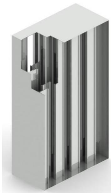
Рисунок 2.1 – Трехмерная модель сепаратора с двутавровыми элементами
