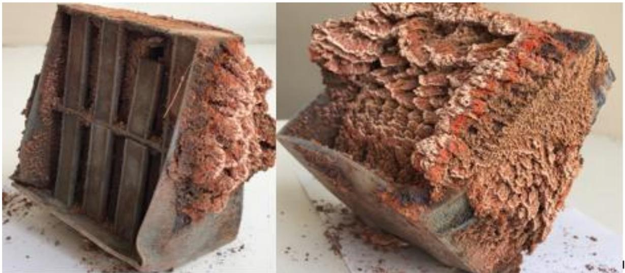
Рисунок 4.3 – Прямоугольный сепаратор после 4 месяцев работы
