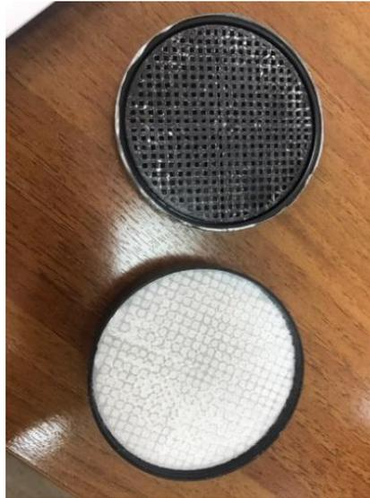
Рисунок 3.13 – Фильтр респиратора после проведения эксперимента
