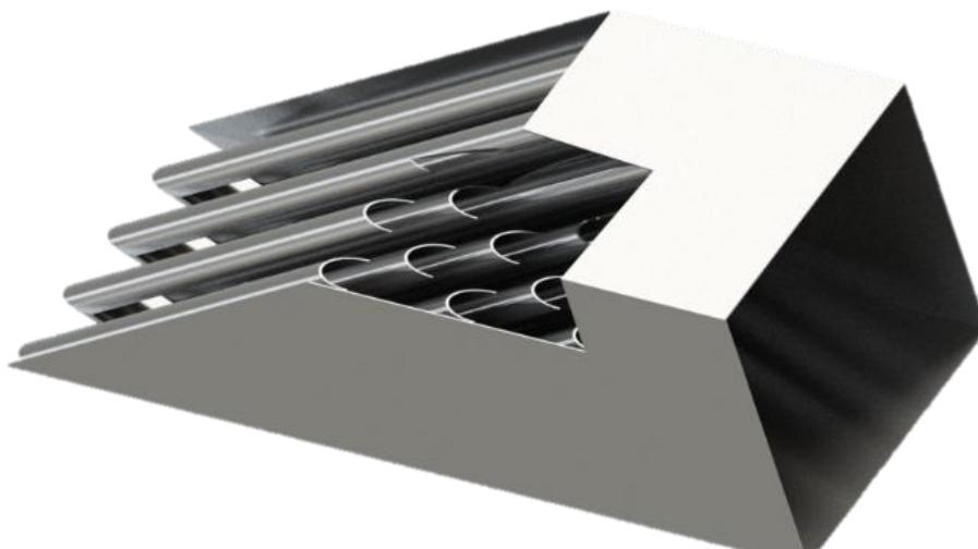
Рисунок 2.2 – Трехмерная модель сепаратора с дугообразными элементами
