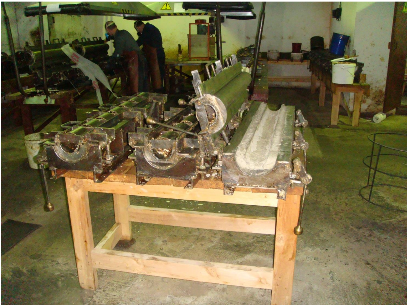
Рис. 4.2 Экспериментальный участок сборки трубной конструкции
