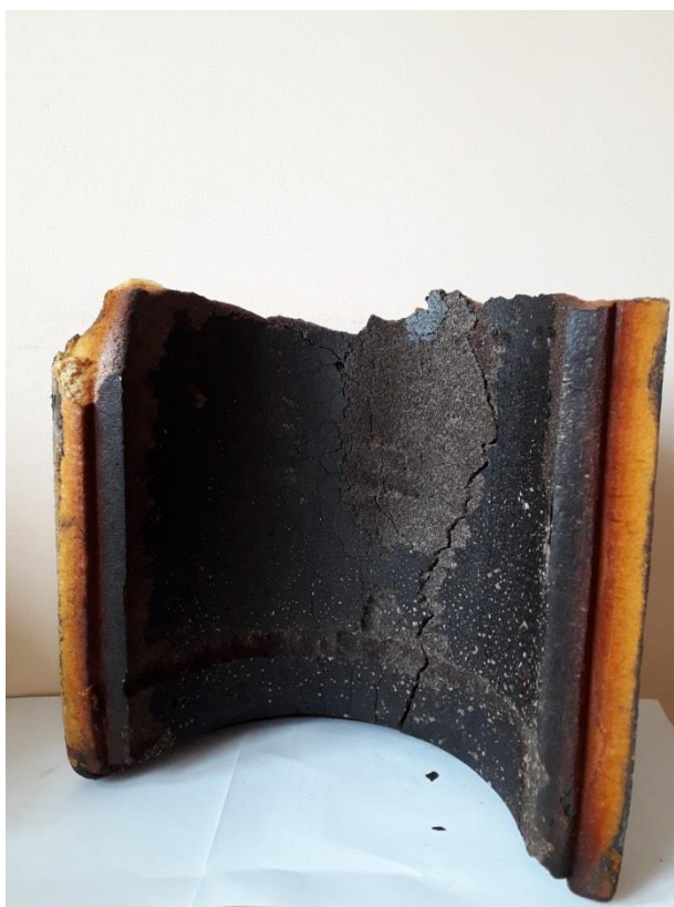
Рис. 1.5 Дефекты ППУ изоляции
