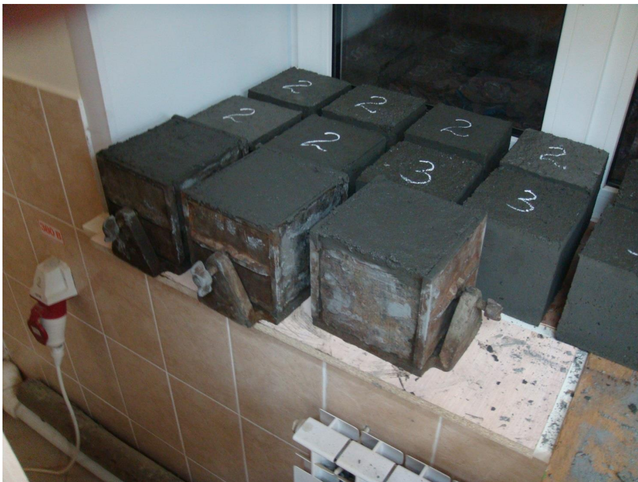
Рис. 3.6 Экспериментальные образцы в металлической опалубке
