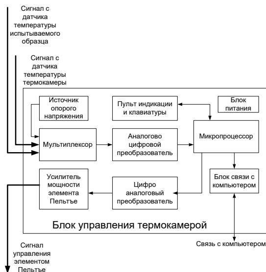
Рис. 6.16. Схема блока управления термокамерой.
