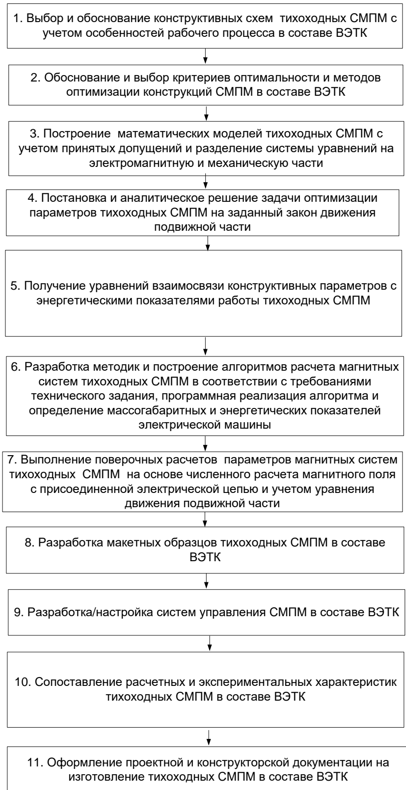
Рис. 2.1. Методологическая схема проектирования оптимальных конструкций магнитных систем тихоходных СМПМ.
