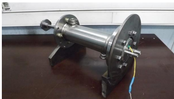
Рис. 5.21. Макетный образец бесмазочной квазиизотермической ступени
