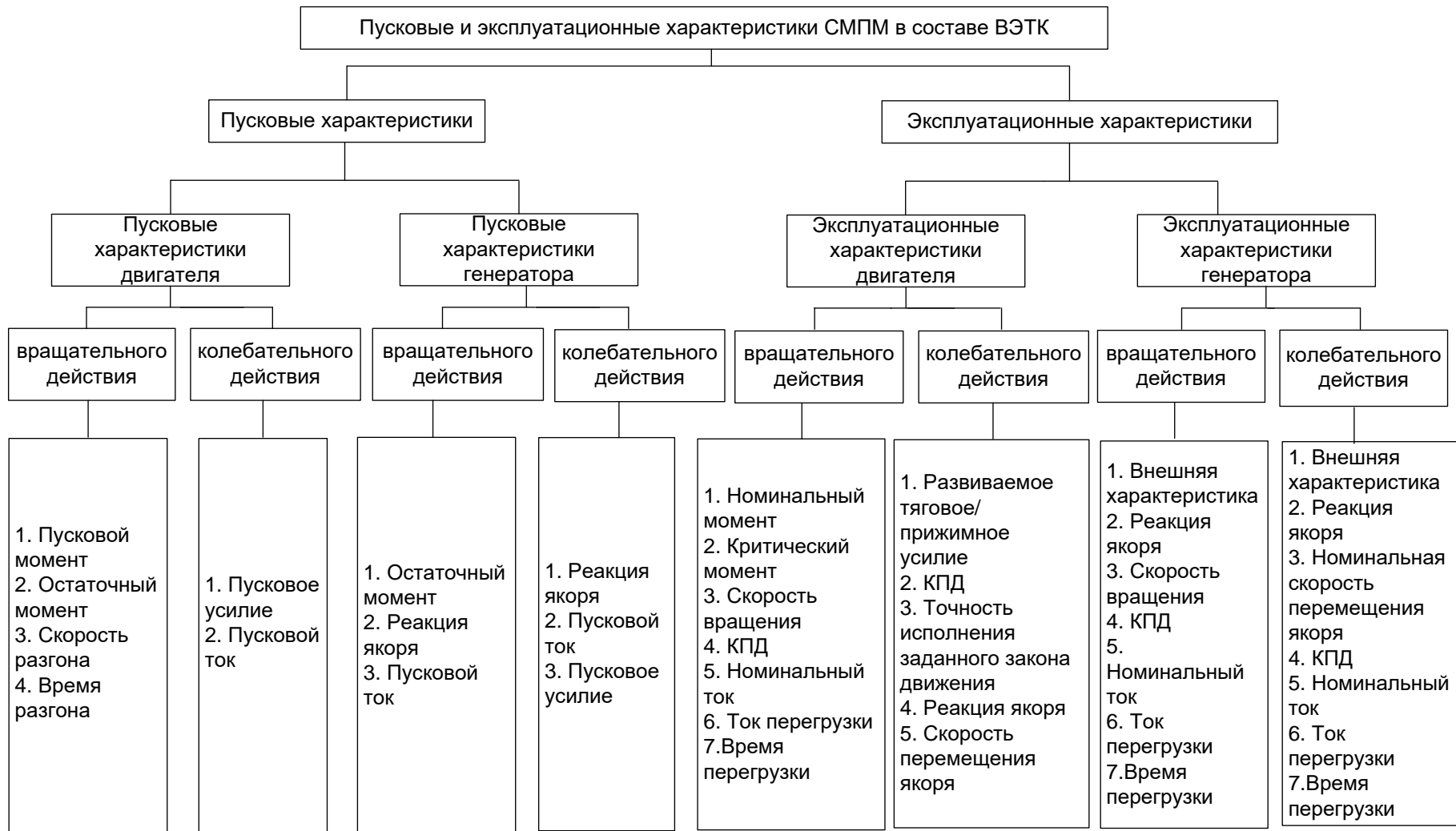
Рис. 1.4. Классификация пусковых и эксплуатационных характеристик тихоходных СМППМ в составе ВЭТК .
