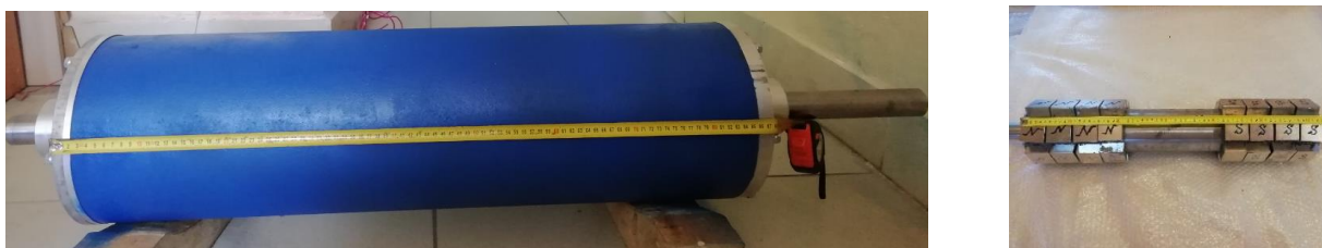
Рис. 5.25. Макетный образец СДПМ для привода поршневого компрессора: а – в сборе, б – индуктор СДПМ.
