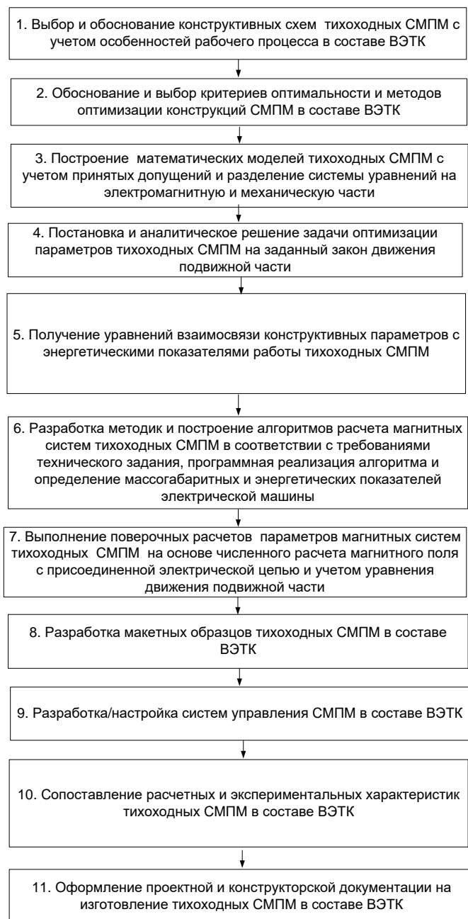
Рисунок 4. Методологическая схема проектирования оптимальных конструкций магнитных систем СМПМ
