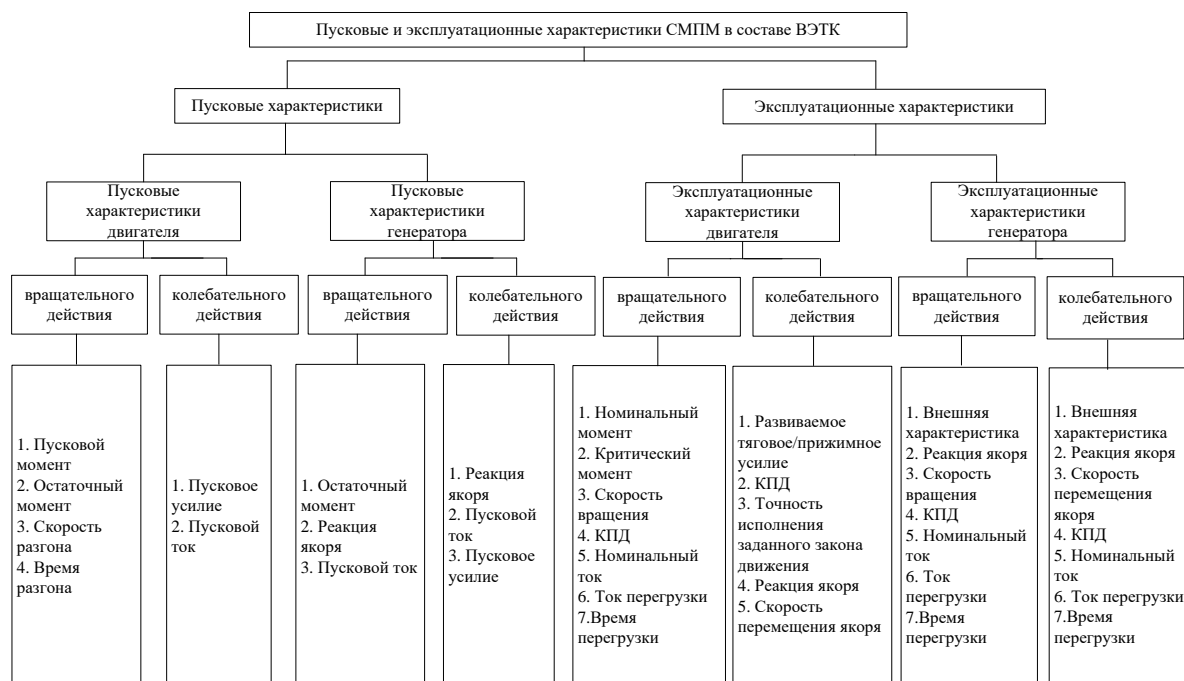
Рисунок 2. Классификация пусковых и эксплуатационных характеристик тихоходных СМПМ в составе ВЭТК
